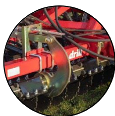
Socs à réglage hydraulique
